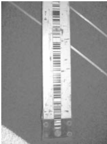
Abb. 10: Stark beanspruchte Latte aus einem Kraftwerk in Slowenien
