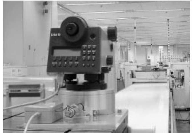
Abb. 7: Drehtisch für das Digitalnivellier mit der Referenzlatte
