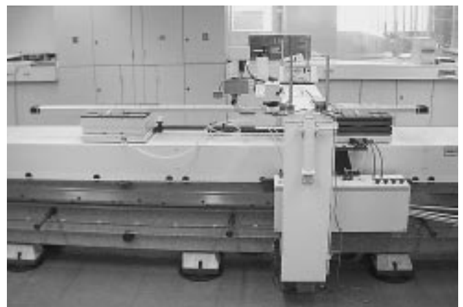
Abb. 5: Horizontalkomparator: Mikroskop und Nivellierlatte
