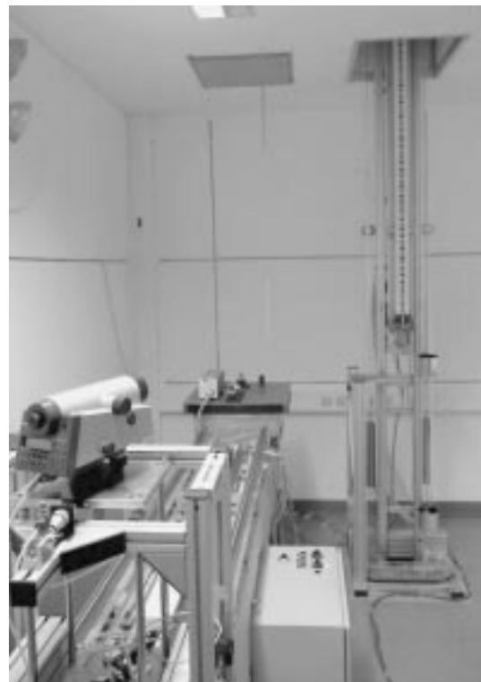
Abb. 3: Der Vertikalkomparator der TU Graz mit Blick vom Instrumentenstandpunkt
