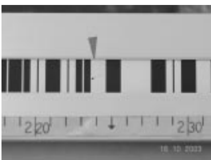
Abb. 3-5: Beschädigung auf der Latte LD 13 (SN 14821)
